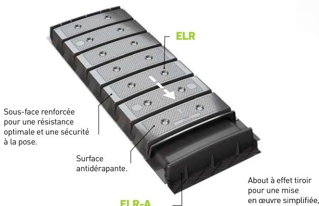
L'entrevoût ELR existe en hauteurs coffrantes 12 et 15 cm. Léger et pratique à mettre en œuvre, pas de déchet ni de chute avec le principe de tiroir. Fabriqué en matière plastique recyclée, sa conception assure sécurité et grande résistance.
