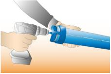
Chanfreiner l'extérieur de la nouvelle extrémité mâle, puis marquer le tube à la hauteur de la scie cloche, à 66 mm.
