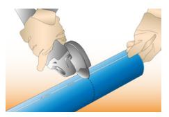
Couper à longueur, perpendiculairement à l'axe le tube à l'aide d'outils appropriés (scie, meuleuse, ...)
