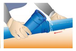
6 - Emboiter les éléments, en poussant dans le sens de la longueur, jusqu'à la marque. Puis retirer de 10 mm afin de permettre la dilatation du tube et l'absorption des mouvements du sol.
