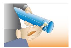
4 - Lubrifier à l'aide de graisse adaptée la partie mâle sur tout le tour du tube et le chanfrein.
