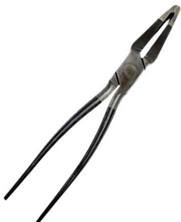
La pince à border est un outil incontournable du couvreur pour effectuer différents plis dans la réalisation de la zinguerie. Vous pourrez facilement plier ou relever la tôle sur une largeur de 80 mm et une profondeur de 60 mm. Notre pince à border de qualité permet des finitions propres en toute sécurité.
