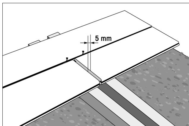
Utiliser exclusivement les clips et vis Cobra®. C'est une condition indispensable à la bonne application de la garantie. Ces clips permettent de garantir le bon espacement entre 2 lames côte à côte.
