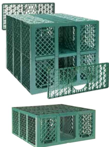
Rigofill inspect est une chambre modulaire en polypropylène vert, pour ouvrage de rétention/infiltration. Elle offre un volume utile de 95 %, soit 950 l d'eau stockée par m<sup>3</sup> brut, et comporte une galerie d'inspection continue. Rigofill inspect s'affranchit de l'utilisation de matériaux de remplissage pour réaliser bassins d'infiltration, de rétention et de stockage. Les boîtes d'inspection
