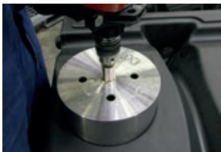
Pour réaliser les raccords de tube DN 200, une perceuse avec scie cloche de  $\varnothing$  200 mm, foret de guidage adapté au plastique compris, doit être mise à disposition par le client.
