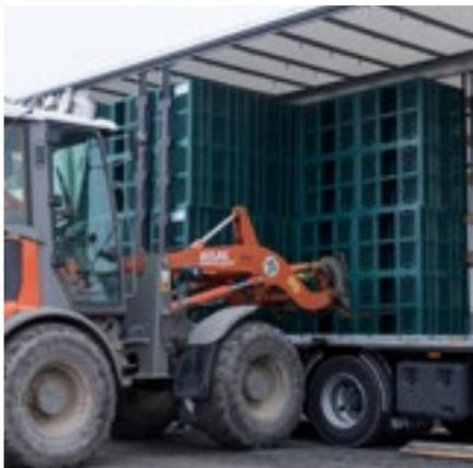
Les blocs Rigofill inspect sont livrés emballés par 4 (8 demi-blocs). Il est préférable de décharger les paquets à l'aide d'un chariot élévateur, d'une grue ou de tout autre dispositif de levage. Les excavateurs doivent disposer de tous les équipements techniques relatifs aux opérations de levage.
