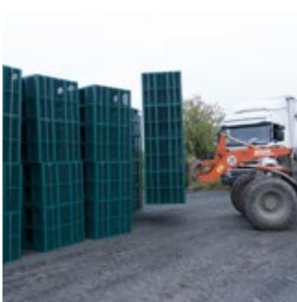
Veiller pour l'entreposage à une fondation plane, solide et propre.
