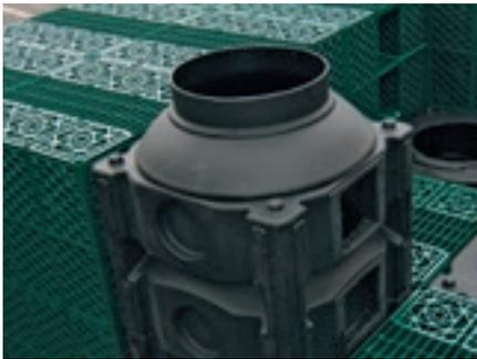
Les regards QuadroControl sont livrés en pièces détachées (partie inférieure, partie supérieure, cône et rehausse de regard) qui doivent être combinées et adaptées sur place en fonction des besoins et selon les instructions suivantes. Par ailleurs, il faut respecter les spécifications de planification.
