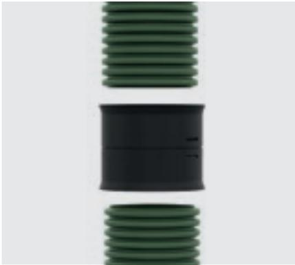
Après la réalisation de l'enrobage par géotextile et du remblai latéral (cf. chapitres suivants), monter les rehausses de regard. Poser le manchon sur le regard RigoControl. Introduire ensuite la rehausse de regard dans le manchon. S'assurer à cet effet que les regards et les rehausses de regard soient installés à la verticale et qu'ils ne basculent pas lors du compactage.
