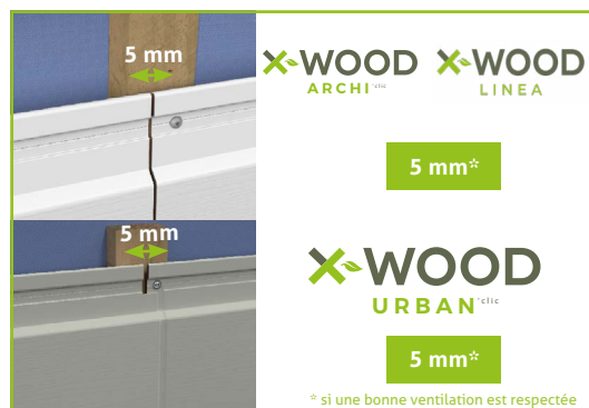
RACCORD MI-BOIS JEU MINIMUM ENTRE LES BOUTS DES 2 LAMES
