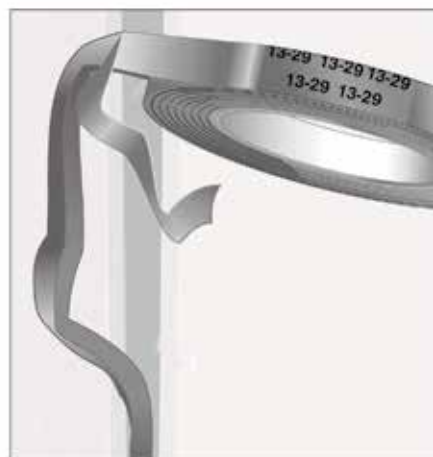
Figure 5: Mise en œuvre le joint existant. illmod 600 est pré-comprimé pour une installation facile voir tableau § 4.5.
