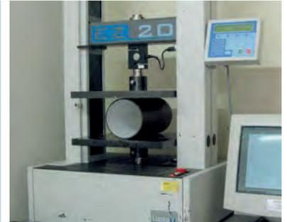
L'essai consiste à placer un échantillon de tube, conditionné au préalable à 23 °C, entre deux plateaux horizontaux que l'on resserre jusqu'à obtenir une déformation égale à 3 % du diamètre intérieur du tube. On mesure alors la force appliquée sur les plateaux pour obtenir cette déformation, et on calcule le module de rigidité (en kN/m<sup>2</sup>) par la formule suivante :
