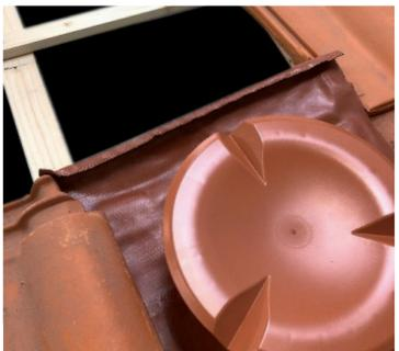
Créer **un relevé** en partie haute avec la jupe afin d'assurer une remontée d'étanchéité optimale et un appui pour les tuiles supérieures.
