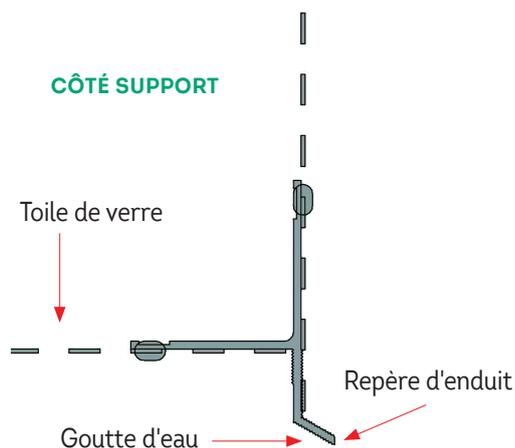
Attention au sens de pose : la trame marquée d'une flèche doit être posée côté façade
