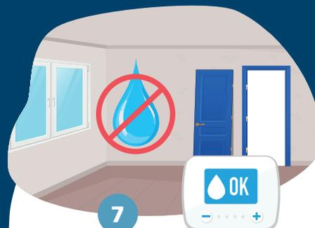
Mettre en œuvre les portes uniquement dans des locaux VENTILÉS hors d'eau et hors d'air dont les ambiances sont proches de celles d'utilisation. L'humidité des bois doit être comprise entre 8 et 14%.
