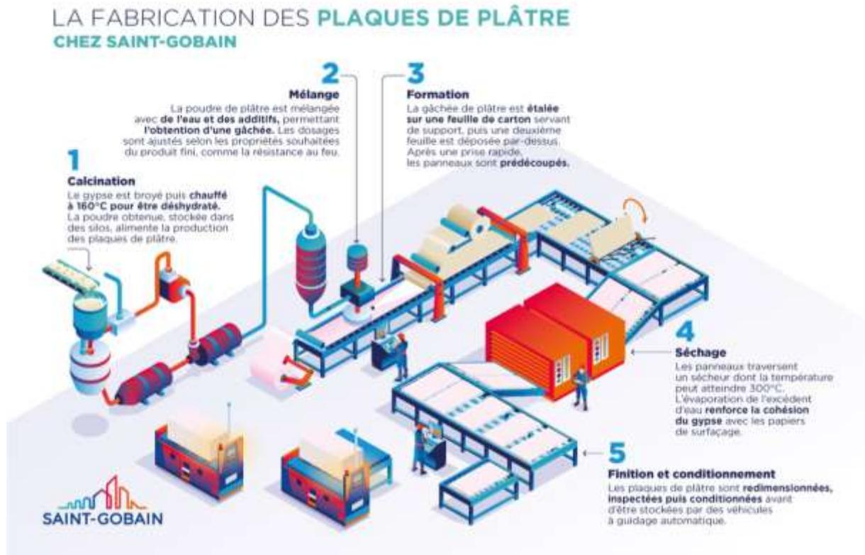
Ce schéma présente le procédé de fabrication des plaques de plâtre. Il ne présente pas l'étape de collage du bloc de polystyrène expansé sur la plaque de plâtre, formant ainsi le complexe de doublage.
