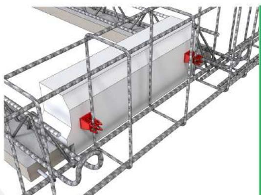
**3** Répéter l'opération en utilisant 2 THERMOPIC par rupteur transversal et 3 THERMOPIC par rupteur longitudinal
