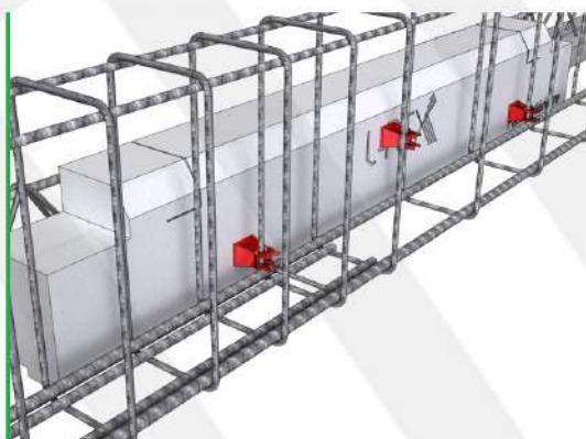
**2** Positionner un rupteur de pont thermique. Placer un THERMOPIC sur un cadre de la poutre et enfoncez la pointe dans le rupteur
