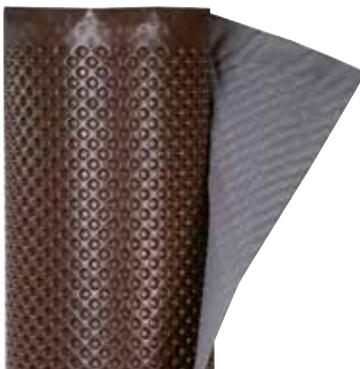
**Protec Drain Filtre** est une protection drainante et filtrante d'une nappe drainante à excroissances avec une structure alvéolée en polyéthylène haute densité et un non tissé filtrant thermosoudé.
