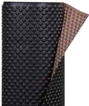
La structure alvéolée est étudiée pour optimiser la répartition de la pression et ménager une lame d'air entre la maçonnerie et l'humidité de la terre. La nappe **Protec Drain** assure la protection des murs enterrés.
