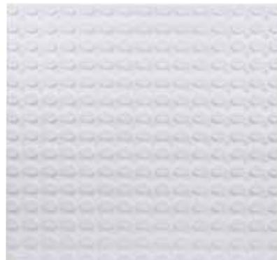
**Sopradrain®** est une plaque drainante en polystyrène expansé.
