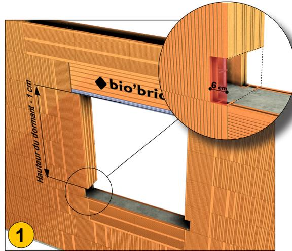
**1** Réaliser les 2 réservations pour le passage de l'appui :
