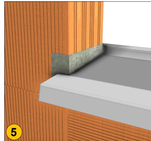
**5** A l'aide d'un mortier, reboucher proprement les 2 réservations. Laisser sécher au minimum 48 H avant la pose des menuiseries. S'assurer de la bonne adhérence de l'appui au mortier.
