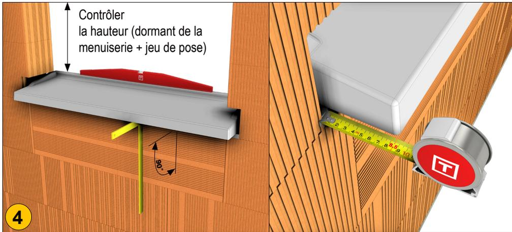
**4** Poser l'appui et procéder aux différents réglages, niveaux, equerrage, hauteur et profondeur. L'appui de fenêtre doit être aligné sur le mur extérieur, débordement de 8,5 cm avant l'application de l'enduit.
