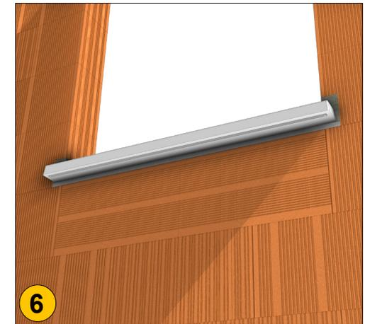
**6** Si nécessaire, boucher et lisser la jonction entre la maçonnerie et le dessous de l'appui. S'assurer de la propreté de la goutte d'eau.
