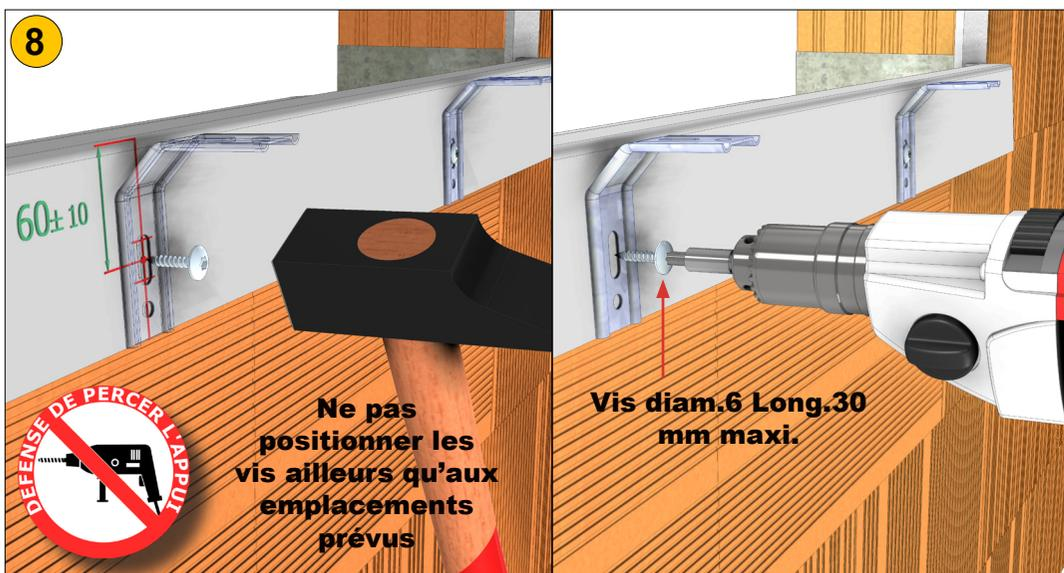
Présenter l'équerre et s'assurer qu'un trou se trouve bien entre 50 et 70 mm par rapport au haut de l'appui. Frapper la vis au marteau afin de casser le voile de béton de 4 mm. Vous pouvez dès à présent finir de fixer l'équerre à l'aide d'une visseuse/dévisseuse. Pour ce faire, utiliser une vis spéciale peinture bois à tête bombée Torx diam.6 Long.30 mm maxi (vis non fournies).
