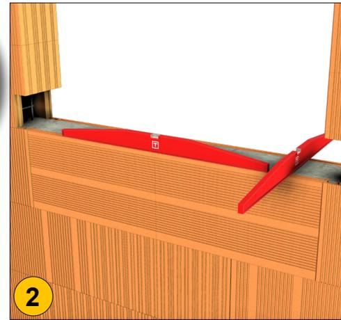
**2** Contrôler les niveaux. S'assurer que la surface n'est pas lisse afin d'assurer l'adhérence du mortier de collage de l'appui.
