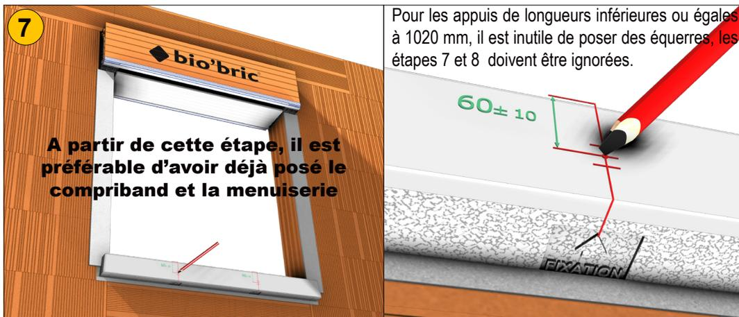
Les inserts polystyrènes sont marqués de repères carrés avec une flèche à l'intérieur. Ces repères permettent de trouver l'emplacement aléatoire des chevilles intégrées dans le produit. Marquer l'emplacement de la cheville dans le prolongement de la flèche. Le tracé devra se situer entre 50 et 70 mm par rapport au haut de l'appui.
