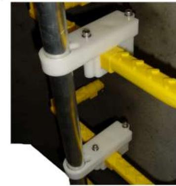
4. Insérer les vis avec leur rondelle dans les trous du bras et procéder de même pour le second échelon
