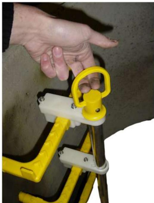
Pour remonter le canne, saisissez le bouchon en plastique et tirez vers le haut en faisant passer l'ergot dans la gorge de la seconde fixation jusqu'au contact du bouchon inférieur. Le verrouillage en position haute se fait par pivotement de 10° de la canne avec mise en place de l'ergot dans le berceau prévu au bras de soutien.
