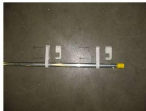
1. Ouvrir les deux fixations à l'aide d'une clé Allen 5 mm en séparant le coffre inférieur du bras de soutien
