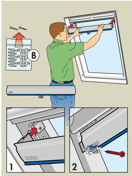
**Nederlands:** Schuif het gordijn in de bevestigingsblokjes (1) en schroef het vast met de schroeven uit zakje B (2).
