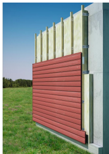
Mise en place d'un pare-pluie
