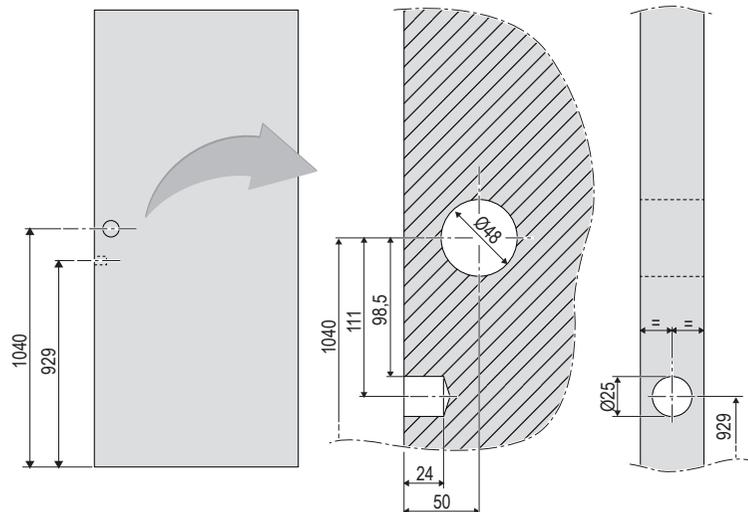
SEQUENZA FORATURA VASCHETTA E CONTROPIASTRA / SÉQUENCE DE PERÇAGE CUVETTE ET CONTRE-PLAQUE / SECUENCIA DE COLOCACIÓN DE EMBELLECEDOR Y CHAPA / SEQUENCE OF DRILLING FOR COVER TRAY AND COUNTERPLATE / BOHRUNGEN FÜR MUSCHEL UND SCHLIESSBLECH / POSLOUPNOST VRTÁNÍ S VANÍČKOU A PROTIPLECHEM
