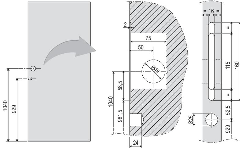
SCHEMA DI FORATURA SENZA SERRATURA / SCHÉMA DE PERÇAGE SANS SERRURE / ESQUEMA DE FRESADO SIN CERRADURA / DRILLING LAYOUT WITHOUT LOCK / BOHRSCHABLONE OHNE VERRIEGELUNG / SCHÉMA VRTÁNÍ BEZ ZÁMKU
