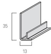
A fixer sur la grille anti-rongeur le long du bord inférieur du mur, il sert à positionner la première lame de bardage, invisible après l'installation.
