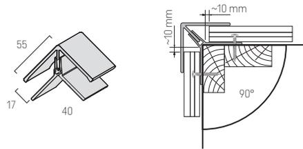
A fixer sur les angles des murs, il peut être utilisé en tant que profil d'angle sortant ou rentrant.
