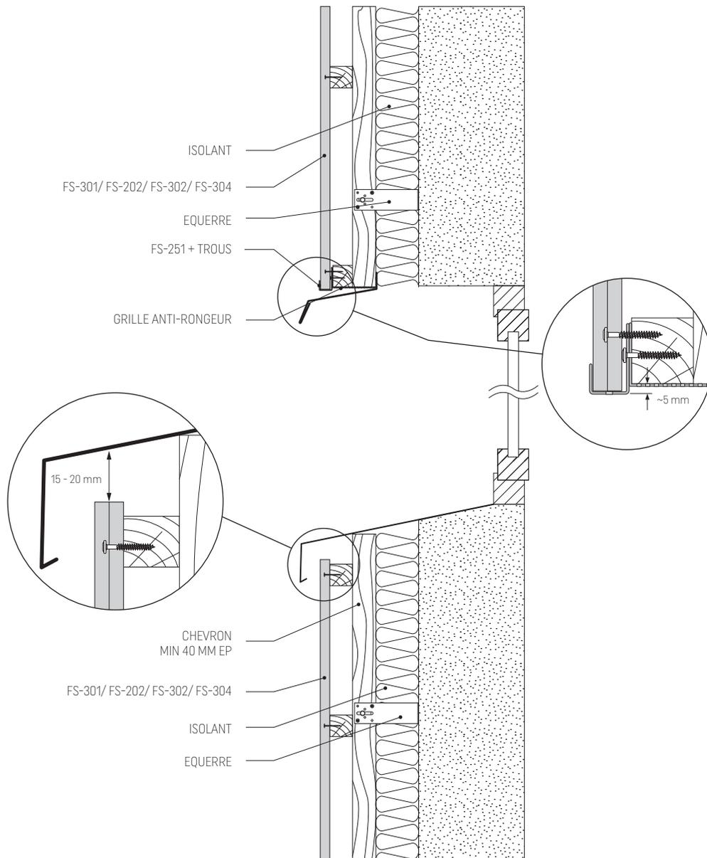
Fig. 23. KERRAFRONT Détail de menuiserie sur mur ossature bois - coupe horizontale
