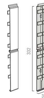
A installer entre deux lames de bardage FS-302 afin de les raccorder sur la longueur, toujours au droit du chevron / tasseau.
