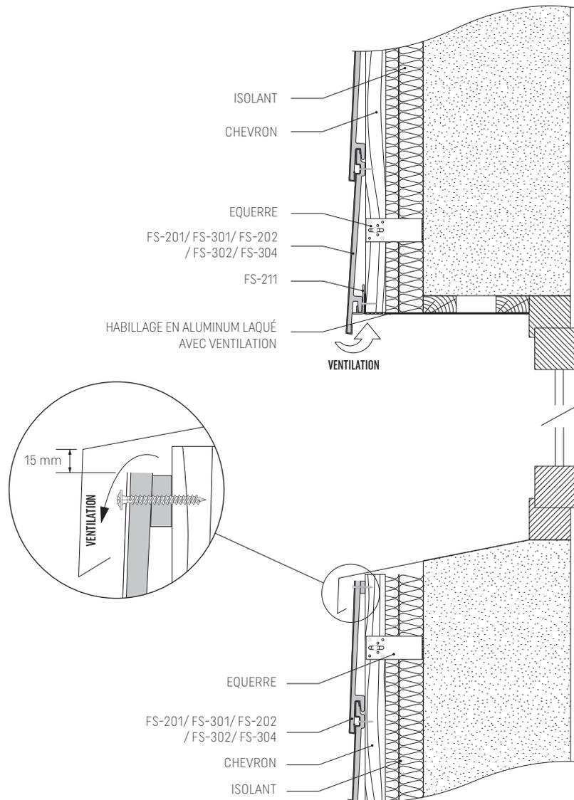
Fig. 18. KERRAFRONT Détail d'angles de menuiserie sur mur maçonné isolé - coupe horizontale
