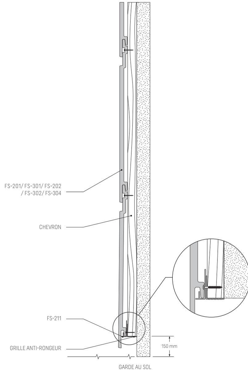
Fig. 13. Lame d'air requise sur mur maçonné - coupe horizontale
