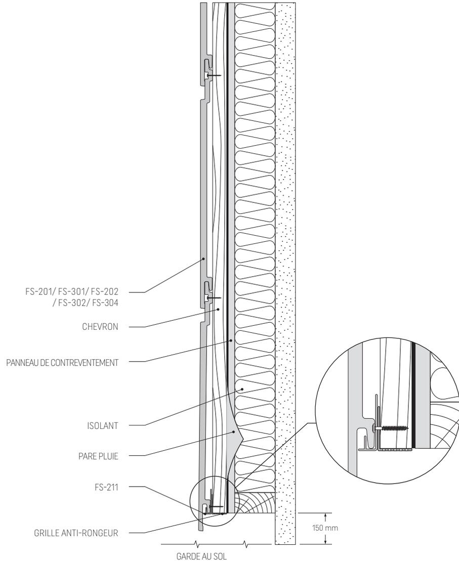
Fig. 8. Lame d'air de 20 mm - coupe horizontale, voir page 7
