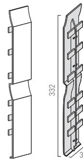
A installer entre deux lames de bardage FS-202 afin de les raccorder sur la longueur, toujours au droit du chevron / tasseau.
