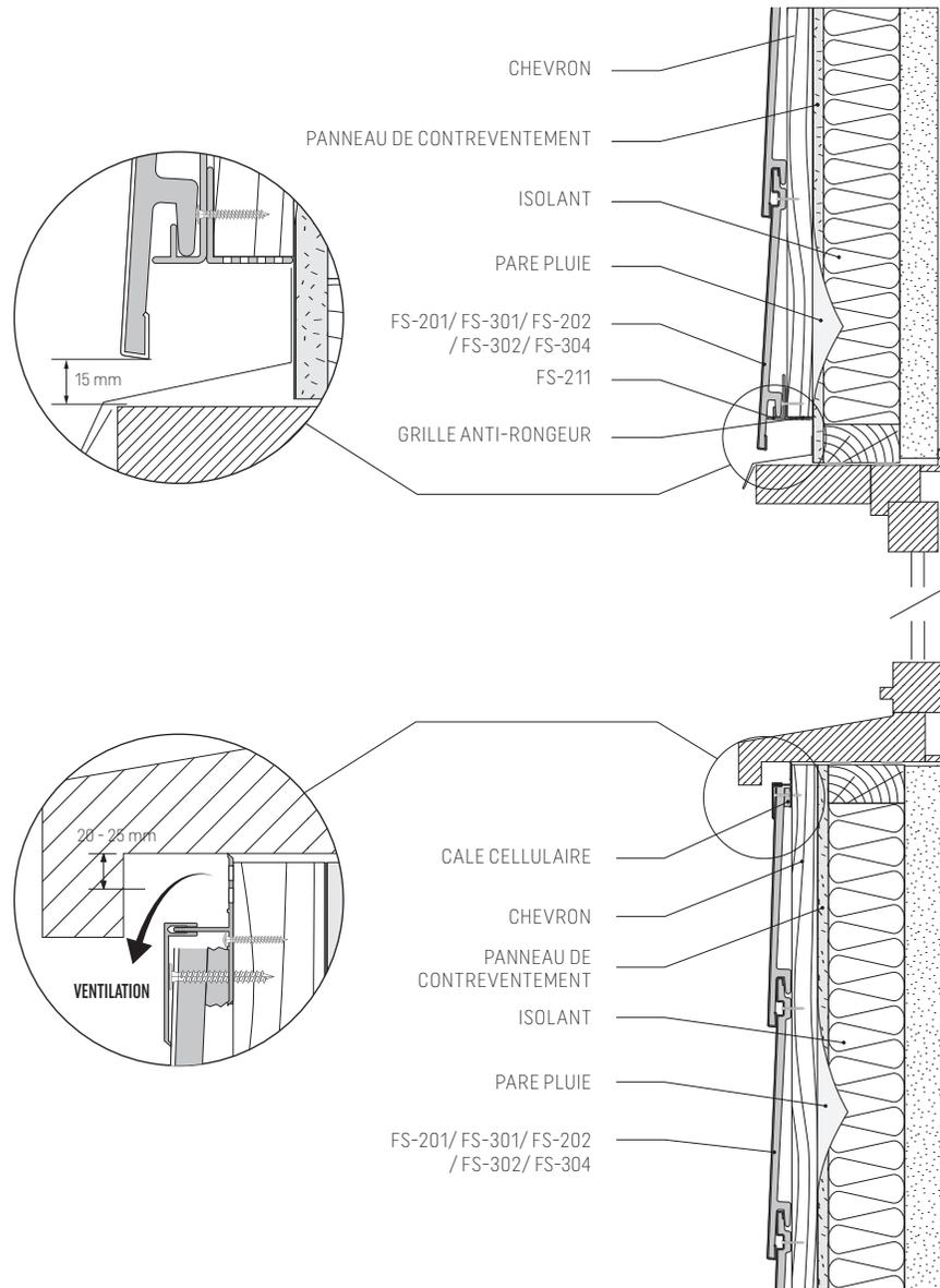
Fig. 11. KERRAFRONT Détail de menuiserie sur mur ossature bois - coupe horizontale
