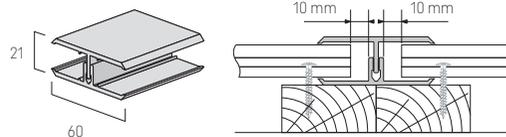
A fixer verticalement pour raccorder les lames de bardage sur la hauteur du mur. Il peut constituer une alternative à la jonction.
