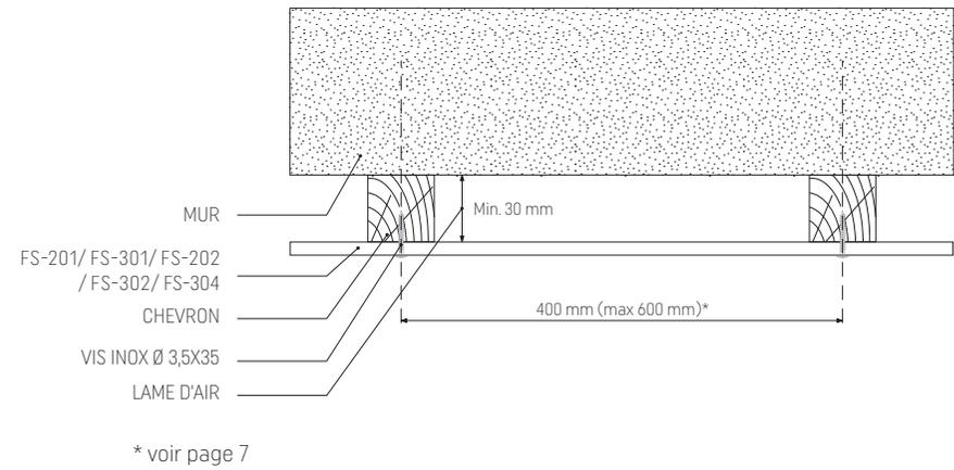
Fig. 14. Lame d'air requise sur mur maçonné isolé entre chevrons - coupe horizontale
