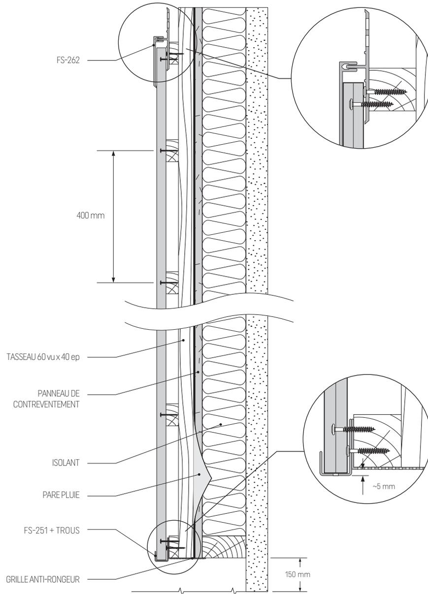
Fig. 21. KERRAFRONT Profil goutte d'eau, détail
