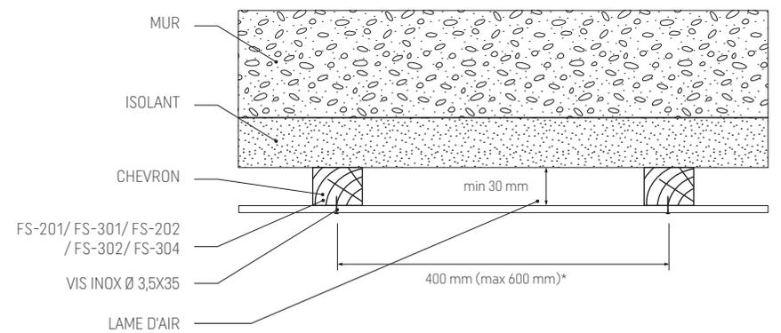
Le mode de fixation du tasseau bois dans le mur porteur est défini par le fabricant d'isolant.
