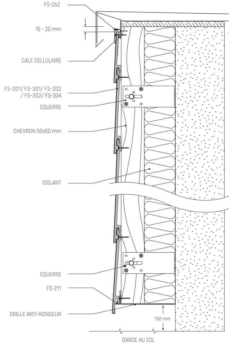
Fig. 16. Lame d'air requise sur mur maçonné isolé avec équerres - coupe horizontale
